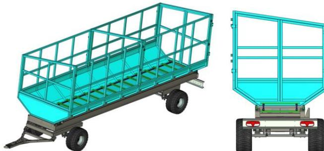
Рис. 1. Общий вид прицепа грузоподъемностью 12 тонн
